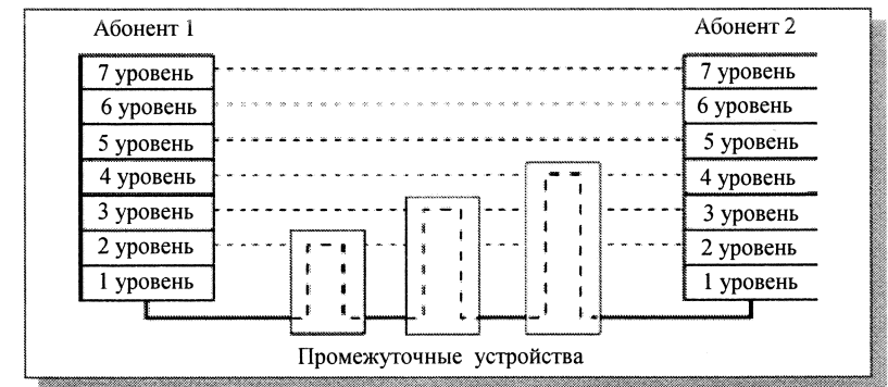
Рис. 2. Включение промежуточных устройств между абонентами сети
